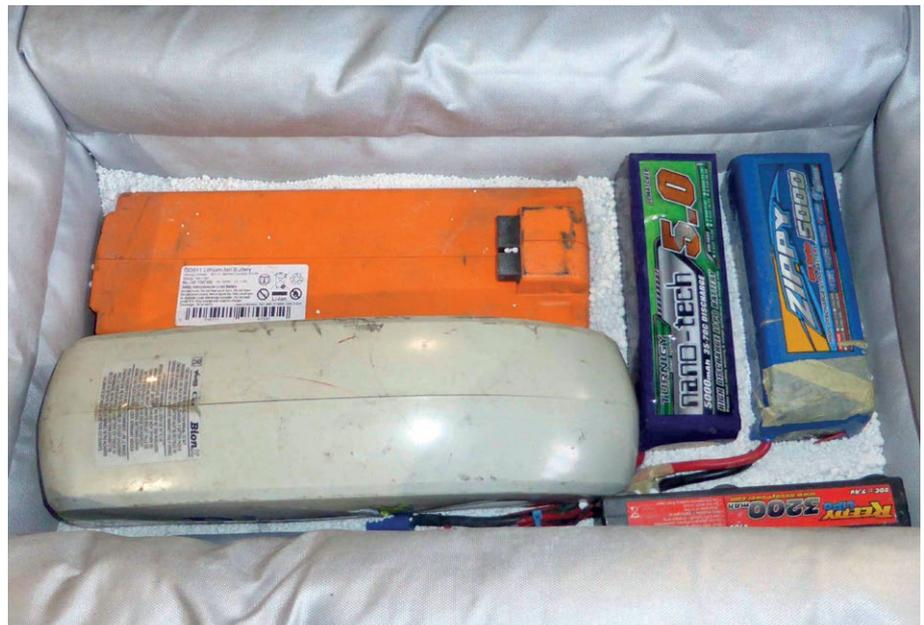
**Abbildung 4:** Brandsichere Kiste von Inobat für sichtbar beschädigte (aufgeblähte) oder erhitzte Lithiumionen-Batterien mit feuerfestem Füllmaterial (PyroBubbles®)
