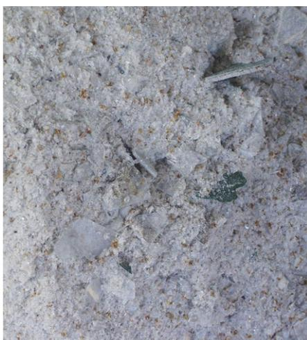
Abbildung 4: Leuchtpulverabfall aus Gasentladungslampen: ein Gemisch aus Glas, Quecksilber, seltenen Erden und Verunreinigungen
