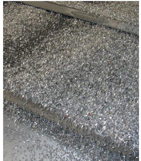
Abbildung 3: Aluminiumgranulat aus der Kabelverarbeitung
